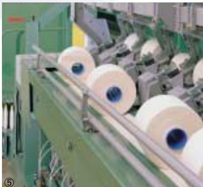
©© Transportband für Kreuzspulen auf vielen Textilmaschinen und in der anschließender Verpackung.
