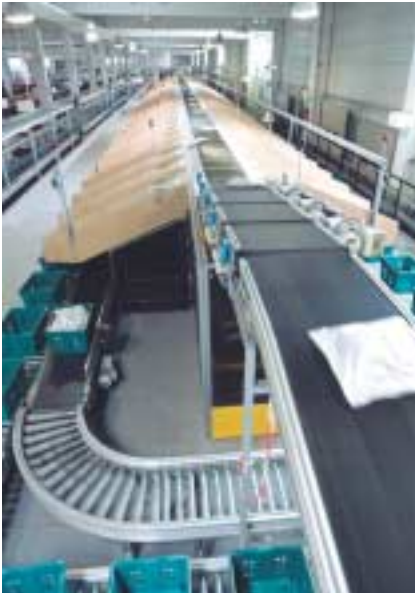
Bei Quergurtsortern erfordert die hohe Beschleunigung extrem gute Reibwerte der Bandoberfläche.
