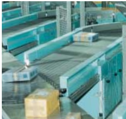
Bei Quergurtsortern erfordert die hohe Beschleunigung extrem gute Reibwerte der Bandoberfläche.
