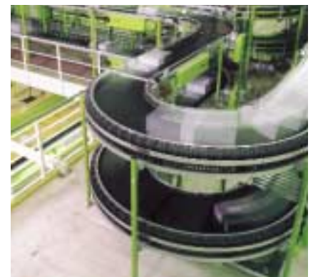
Kurvengurtförderer in einem Verteilzentrum.
